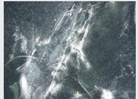
*Estas imágenes ampliadas muestran fuertes marcas de flexión del film, confirmando que el origen de los poros es el agrietamiento por flexión.*
